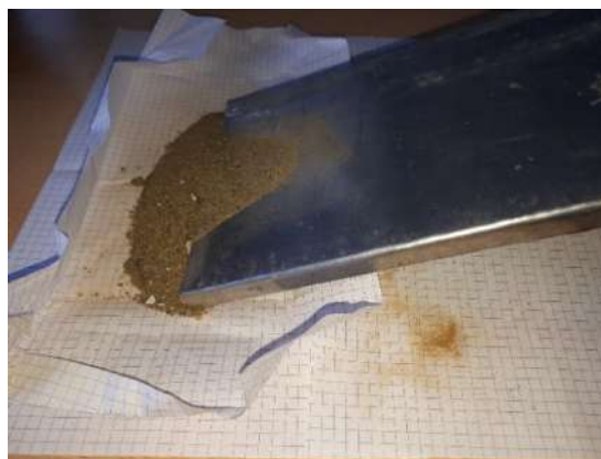
Рис. 7. Испытание по определению угла скольжения песка.
