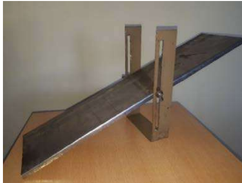
Рис. 5. Испытательный стенд для определения угла скольжения пород.
